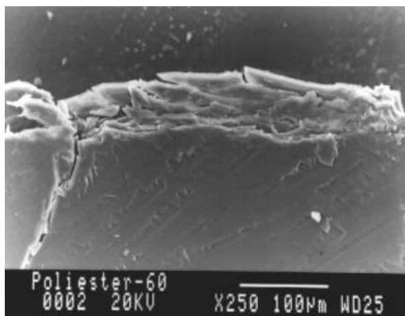
FIGURA 4 – Fotomicrografia Obtida por Microscopia Eletrônica de Varredura de uma Amostra do Poliéster da Bobina 60.
