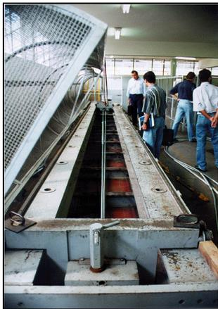
**FIGURA 6** – MÁQUINA HORIZONTAL DE MEDIÇÃO DE TENSÃO DE RUPTURA.
