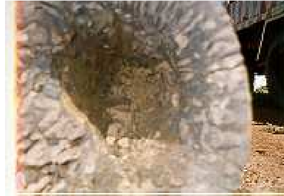
Amostra de poste atacado por cupins
