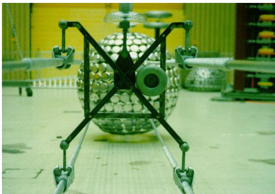
FIGURA 5 – Detalhe do protótipo de ferragem da fase lateral, com espaçamento regular, para 4 condutores RAIL (954 MCM), desenvolvido pelo CEPEL
