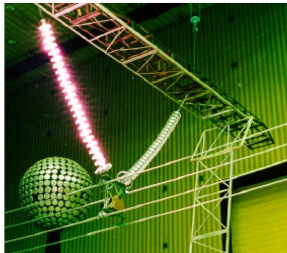
FIGURA 8 – Ensaio de determinação da tensão suportável de impulso atmosférico
