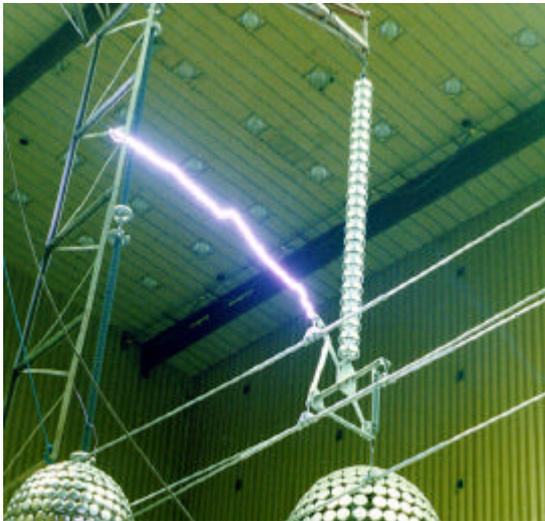
FIGURA 9 – Ensaio de determinação da tensão suportável de impulso de manobra
