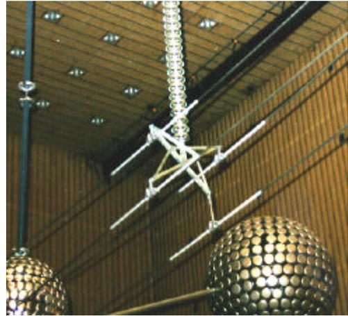
FIGURA 2 – Ferragem da fase lateral LPNE/FEX 500 kV da CHESF – ensaio de distribuição de potencial na cadeia realizado no CEPTEL
