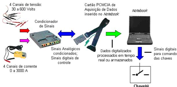
FIGURA 8. Dispositivos utilizados na estrutura do chaveamento controlado.
