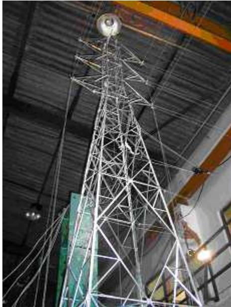
FIGURA 4 – Modelo reduzido da torre preparada para os testes de carga.
