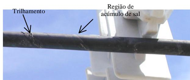
Figura 8: Detalhe do espaçador do fabricante C, onde pode ser observado trilhamento sobre o cabo na extremidade da amarração e região de acúmulo de sal.
