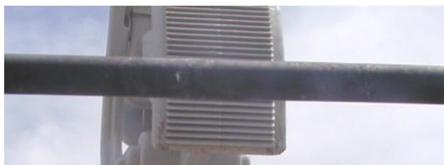
Figura 6: Detalhe do cabo em contato com espaçador do fabricante A apresentando pouca alteração comparando com os demais espaçadores.
