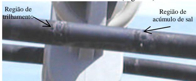
Figura 7: Detalhe do espaçador e acessórios do fabricante B, onde pode ser observado acúmulo de sal e pontos de trilhamento.
