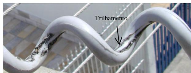
Figura 9: Detalhe do laço de amarração do fabricante C, onde pode ser visto trilhamento, onde o laço tem contato com o cabo.
