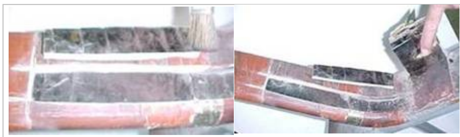
FIGURA 6 – Região da cabeça da bobina, fora do núcleo.
