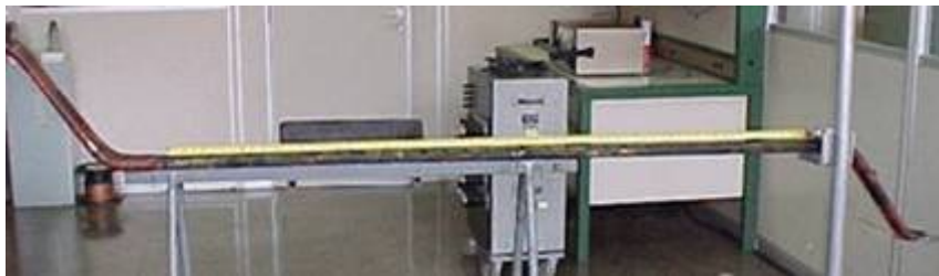
FIGURA 1 – Barra da armadura, classe B, nos laboratórios de FURNAS.
