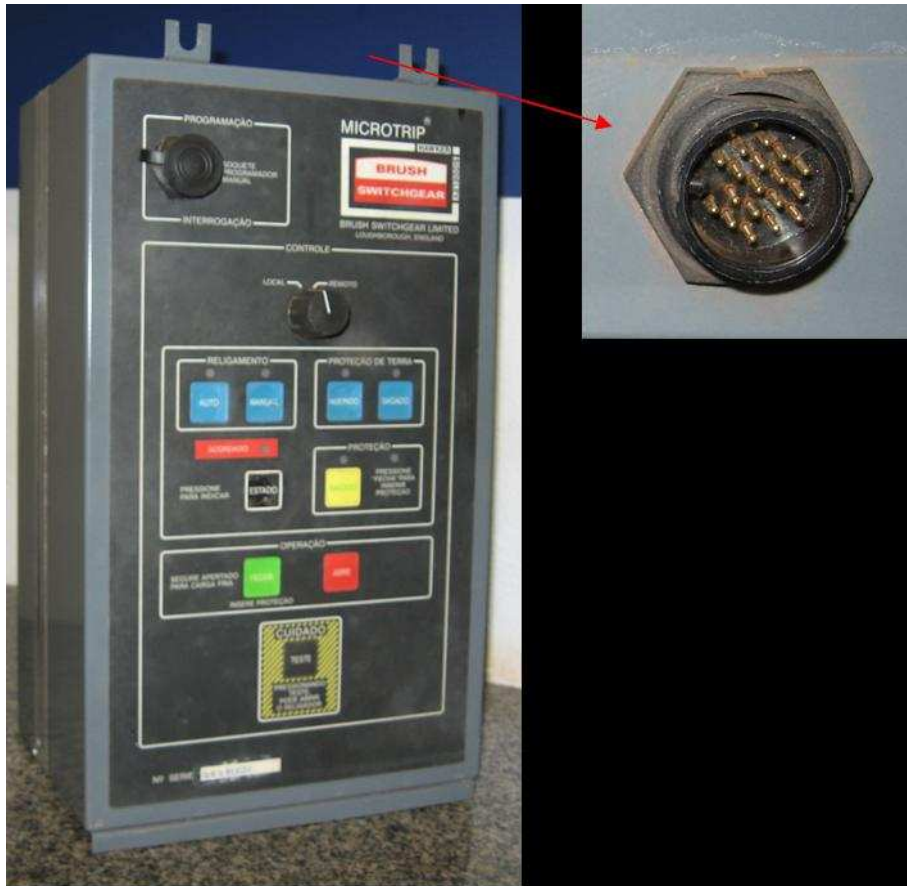
Relé Microtrip I e conector utilizado para alimentação externa
