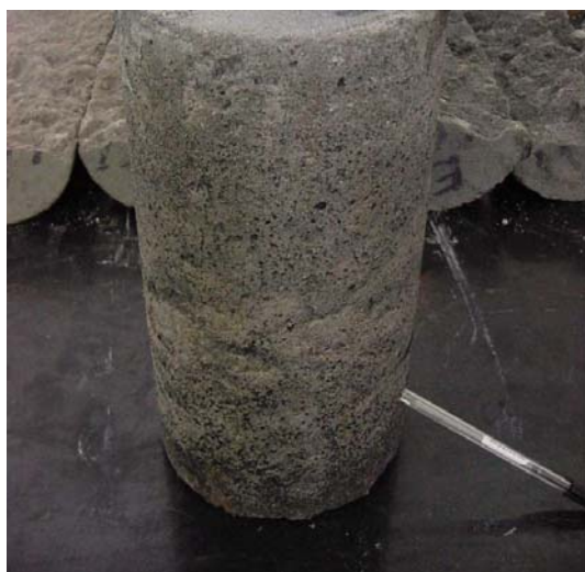
Figura 7 – Corpos-de-prova após desmoldagem ilustrando segregação das partículas de borracha (a caneta indica a região de segregação no topo do corpo-de-prova)
