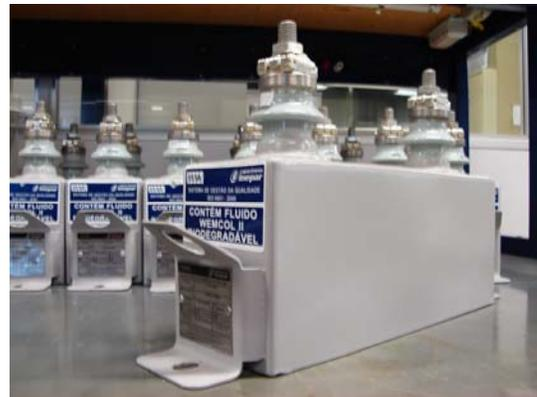
Fig. 5. Capacitor MT fabricado em escala reduzida especialmente para os testes.
