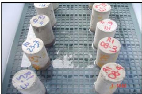
Figura 7. Ensaio – Absorção por Capilaridade
