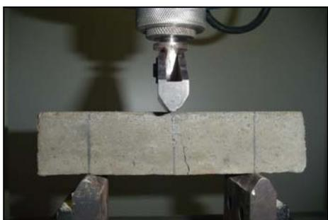
Figura 4. Ensaio – Resistência à Tração na Flexão
