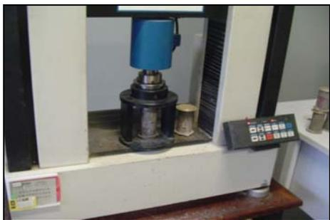
Figura 3. Ensaio – Resistência à Compressão Axial
