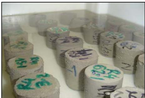
Figura 6. Ensaio – Absorção por Imersão
