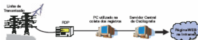
Figura 1. Representação do processo de coleta automática de registros adquiridos pelos RDPs.
