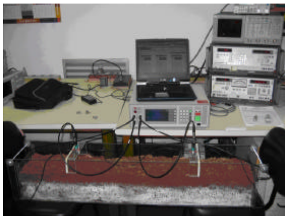
Figura 4: Ensaio para a obtenção dos parâmetros elétricos de amostra de solo.
