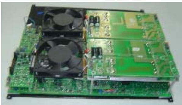
Figura 02 – Módulo do amplificador de corrente
