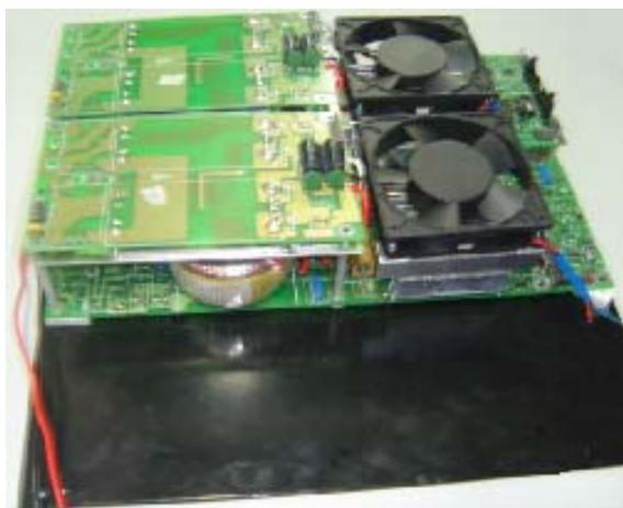
Figura 03 – Módulo do amplificador de tensão
