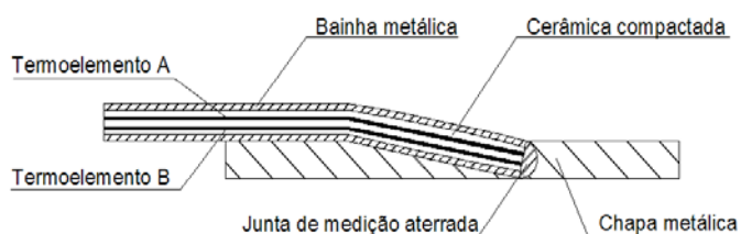
Figura 9. Sensor de temperatura de superfície com junta de medição aterrada.
