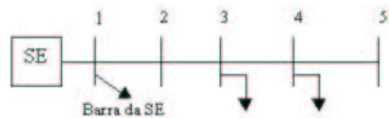
Fig.6 Sistema-Teste Radial Utilizado nas Simulações Computacionais
