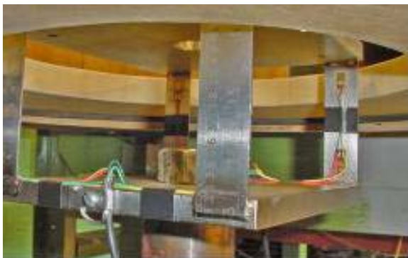
Figura 5. Detalhe da balança de medições de forças de arrasto.
