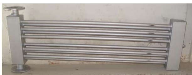
Figura 5. Trocador de calor
