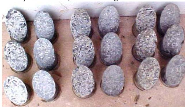
figura 3 – Espécimes adesivos industrializados, rompidos aos 3 dias, demonstrando ruptura na junta, especialmente entre o concreto do substrato e o adesivo.
