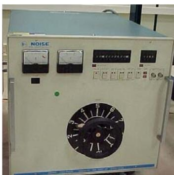
Figura 4 - Simulador de VTCD na rede elétrica
