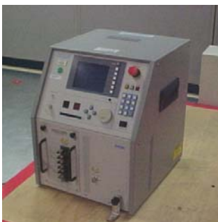
Figura 11 - Simulador de transitórios elétricos rápidos
