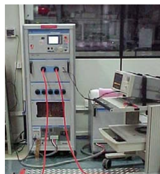
Figura 8 - Gerador de Impulso
