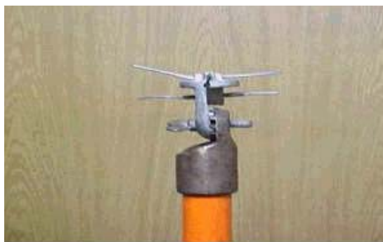
FOTO 5 - Ponteira Adaptada na Vara para Limpar
