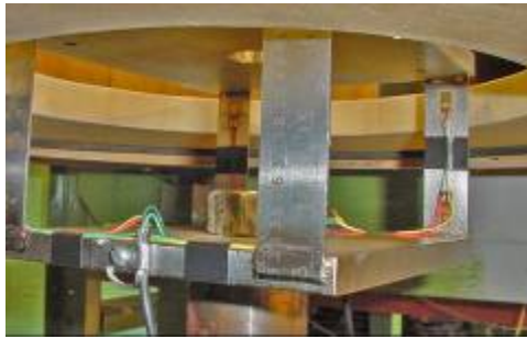
FIGURA 4 – Detalhe da balança de medições de forças de arrasto.
