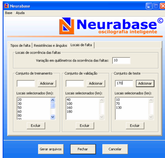
FIGURA 5 – Interface para separação dos conjuntos de treinamento, validação e teste.
