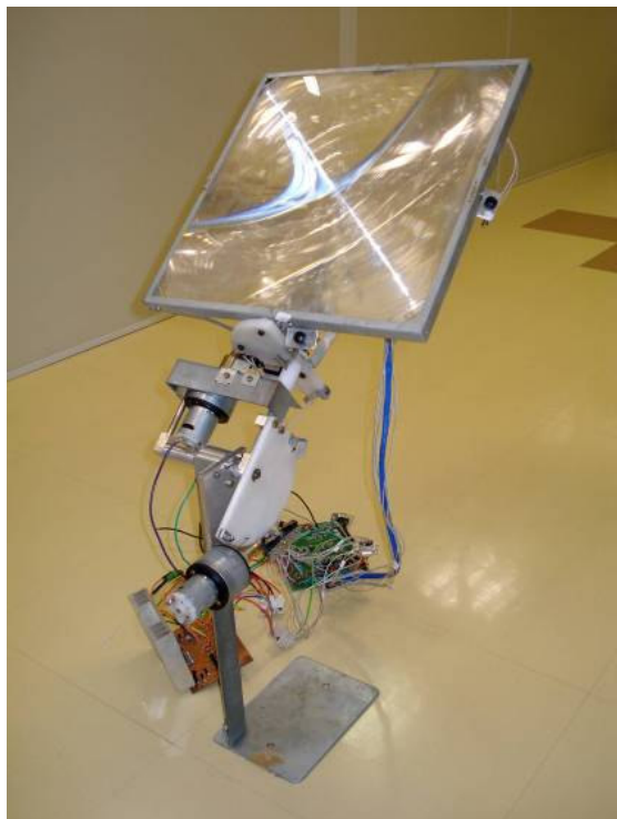
Figura 7 – Protótipo do coletor solar montado.
