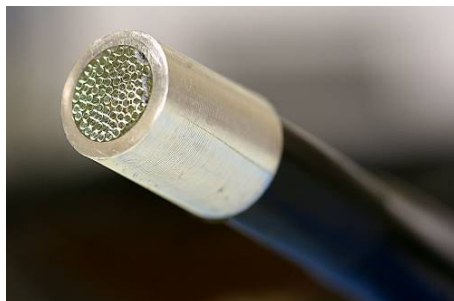
Figura 8 – Detalhe do acabamento da extremidade da fibra óptica plástica.
