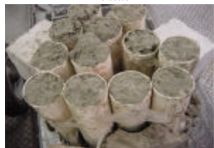
Fotografia 21 - Remoção dos Tubos de PVC da Campânula Sob Pressão de 9 kgf/cm 2
