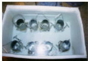
Fotografia 23 - Fôrmas de 100 mm x 200 mm Imersas no Tanque d'Água
