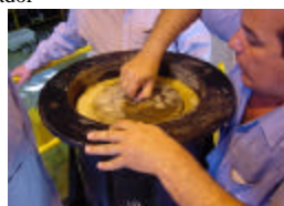
Fotografia 3 – Colocação do Disco Metálico
