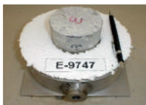
Fotografia 27 - Colocação do Anel de Isopor para Liberação da Junta
