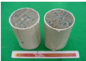
Fotografia 22 - Aspecto dos Tubos Após o Corte nas Dimensões de 75 mm x 150 mm
