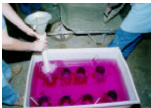
Fotografia 24 - Colocação do Concreto Submerso nas Fôrmas (concreto sem pressão)
