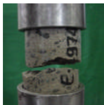
Fotografia 32 - Detalhe da Ruptura Fora da Junta - Ruptura no Concreto Velho
