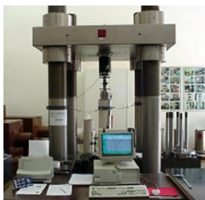
Foto 34 – Realização do Ensaio Uniaxial na Prensa Servo-controlada – Cap. de 500 t
