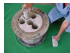
Fotografia 7 - Extração dos Testemunhos do Concreto
