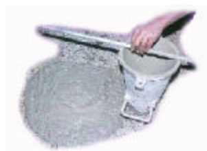
Fotografia 18 - Abatimento do Concreto no Tronco de Cone
