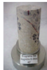
Figura 9 e Fotografia 35 Ensaio de Compressão Triaxial – Dosagem E-9906 – Inclinação da Junta 40°
