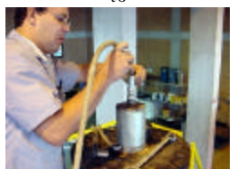
Fotografia 4 - Conexão da Mangueira de Ar Comprimido na Câmpula Superior para Aplicação da Pressão.
