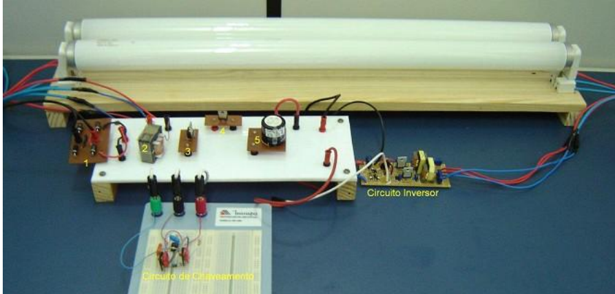
Figura 10– Módulo de entrada, composto por: 1- ponte de diodo, 2- indutor, 3- MOSFET, 4- diodo ultra rápido, 5- capacitor eletrolítico de saída.
