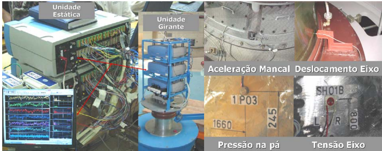
FIGURA 3 – Condicionadores estáticos e girantes
