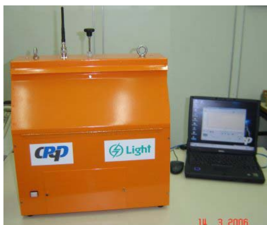
Figura 3: Sistema de detecção da corrosão em linhas de distribuição de energia.
