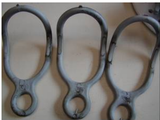
Figura 4. Anéis de amarração do fabricante B: elevada deformação permanente e trilhamento elétrico.
