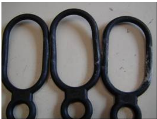
Figura 5. Anéis de amarração do fabricante D: pequena deformação permanente e leve trilhamento elétrico.
