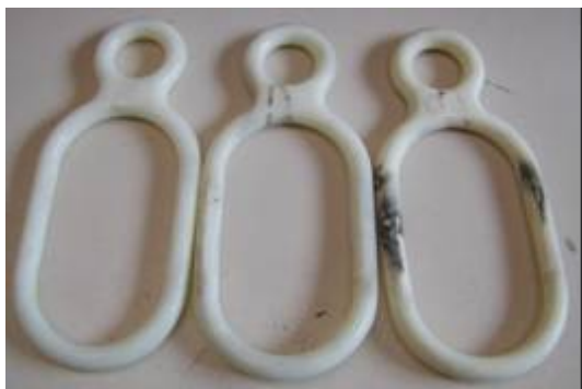
Figura 6. Anéis de amarração do fabricante C: nenhuma alteração significativa.
