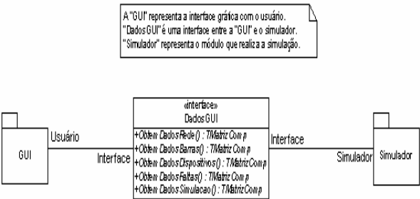
Figura 1 - Estrutura simplificada de um simulador dinâmico.
