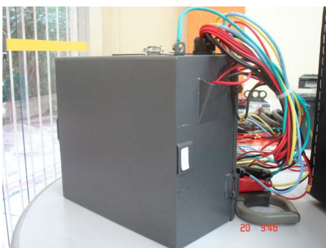
Figura 3 – Módulo GEMOREL no compartimento para fixação em ambiente externo.
