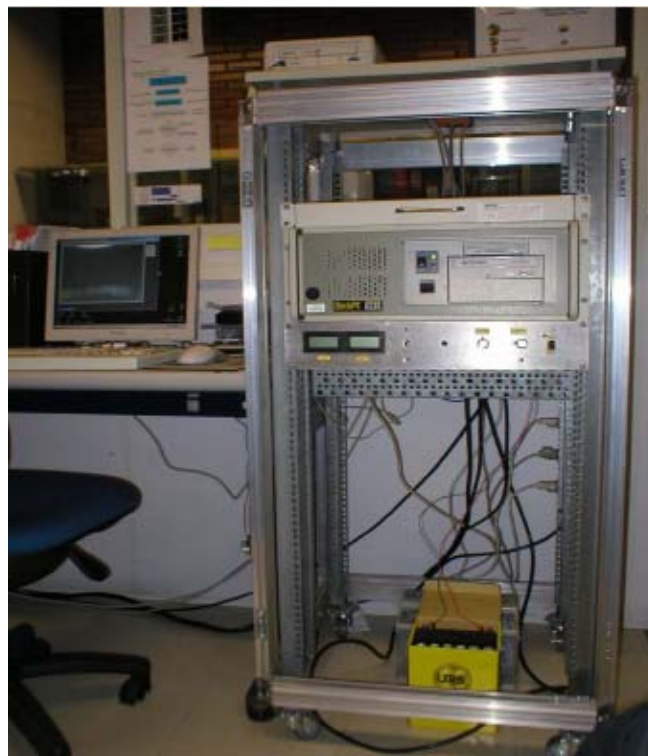
Figura 8: Rack portátil com o controlador do gerador de raios-X e o computador do sistema.
