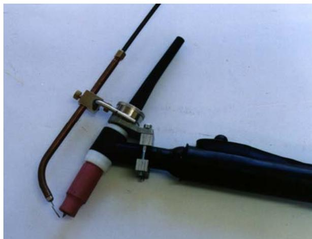
Fig. 3 – Tocha TIG Adaptada com Suporte Direcionador de Arame [3].
