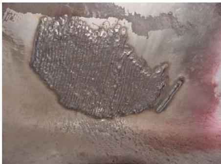
Fig. 18 – Depósito realizado em campo com Plasma Alimentado, de CAVITEC 1,2 mm de diâmetro
