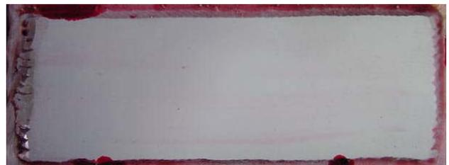
Fig. 16 – Depósito de CAVITEC 1,6 mm de diâmetro, confeccionado com corrente duplamente pulsada, de forma automatizada.
