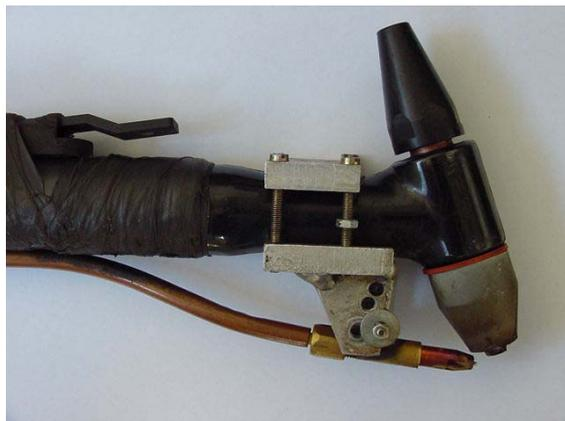
Fig. 8 – Segundo Protótipo da Tocha Plasma Adaptada
