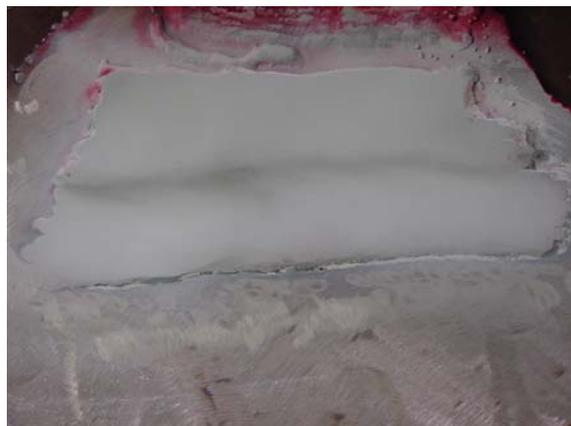
Fig. 19 – Depósito de Hidroloy 1,2 mm de diâmetro, com corrente duplamente pulsada
