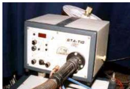
Fig. 4 – Sistema Tracionador de Arame para o Processo TIG – STA-TIG.
