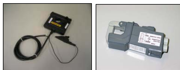
Figura 2. Sensores de corrente (a) experimental e (b) adotado.
