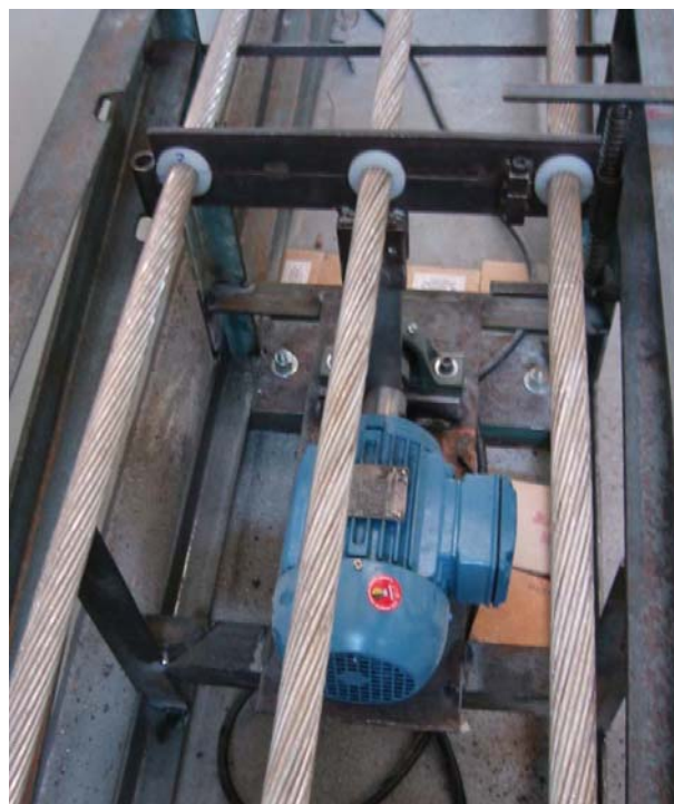
Figura 03 -Sistema de vibração.
