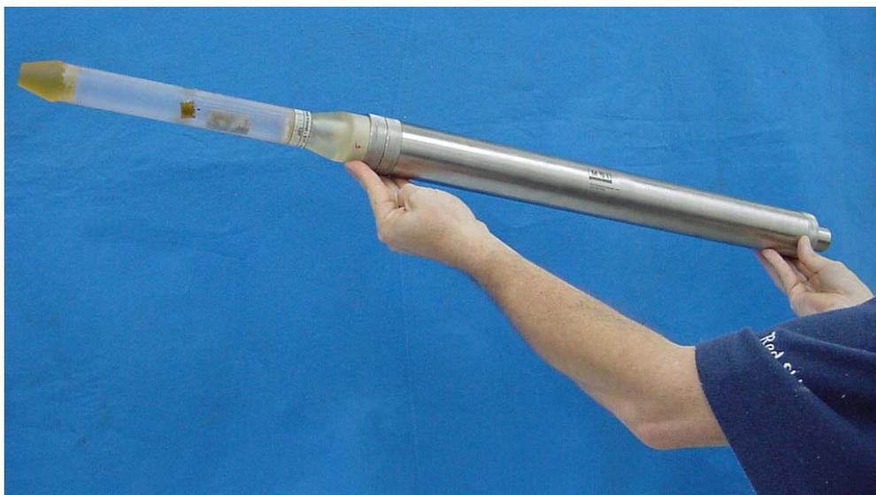
Figura 8: Célula triaxial acoplada ao módulo de aquisição de dados.
