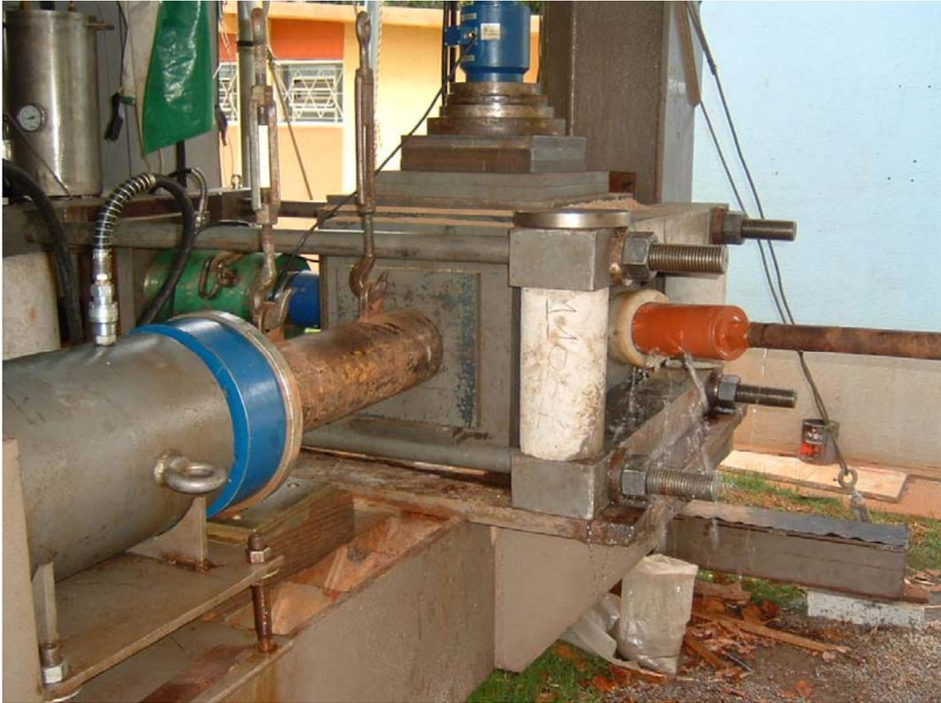
Figura 5: Ensaio triaxial – Notar à direita o barrilete para execução da sobrefuração (overcoring).
