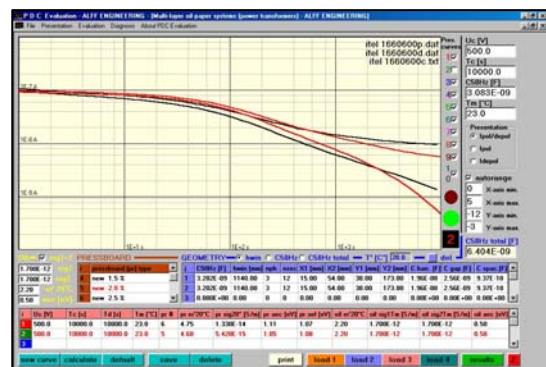
Fig. 9: PDC apresentando 2% de H 2 O somente após secagem da parte ativa do Passo 4.
