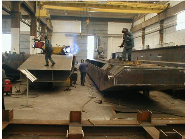
FIGURA 4– Fabricação das vigas espelho
