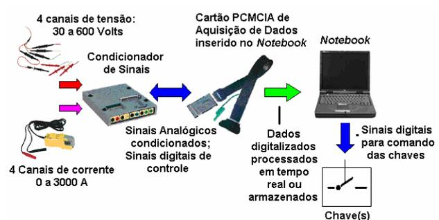
FIGURA 7 - Ilustração dos dispositivos físicos utilizados na estrutura para o chaveamento controlado.
