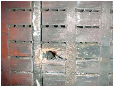
Foto 02 - Fusão das lâminas do núcleo entre as ranhuras 422 e 423
