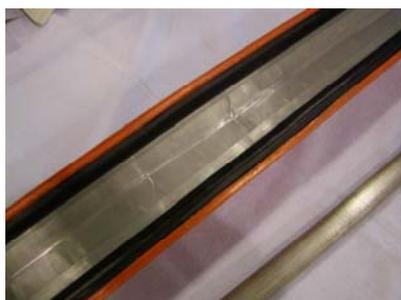
**Figura 13:** Vista do eletrodo externo usado no ensaio de coberturas sólidas de condutores.
