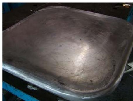
Figura 11: Vista do eletrodo confeccionado para o ensaio em mantas isolantes.
