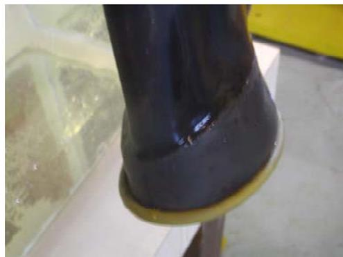
Figura 6: Vista do punho da manga com inchamento devido ao uso do freon no ensaio.
