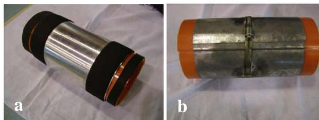
**Figura 15:** Em a: Vista do eletrodo externo, sistema com velcro, usado nos ensaios de cobertura de poste. Em b: Vista do eletrodo externo, sistema de aperto com parafuso, usado nos ensaios de cobertura de poste.
