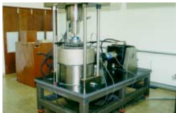
Figura 9 Equipamento servo controlado para Ensaio de Cisalhamento Direto
