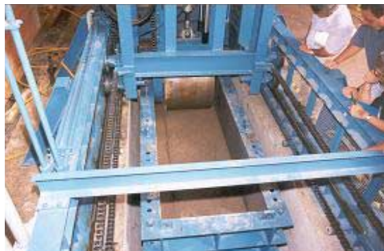
Figura 5. Vista do equipamento de compactação em funcionamento
