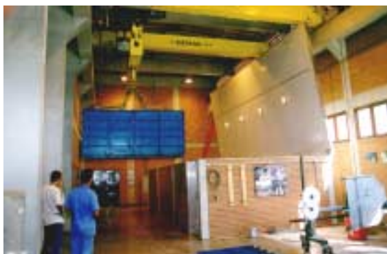
Figura 3. Maciço Experimental sendo transportado para a Câmara Úmida
