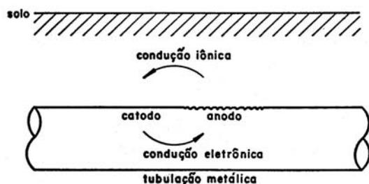
**Figura 1. Ilustração esquemática de célula de corrosão na superfície de uma tubulação metálica enterrada.**
