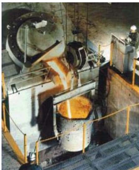
**Figura 1- Exemplo de Forno de Indução**
