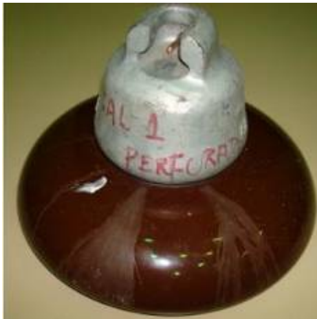
(a) – Isolador perfurado mas com aspecto de íntegro
