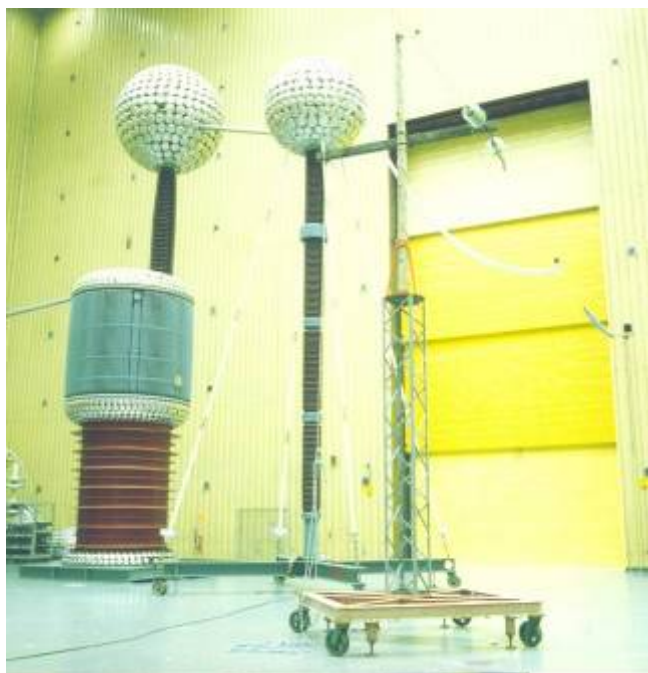
(a) – cadeia de ancoragem para 34,5 kV
