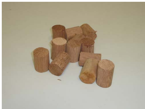
Figura 7. Cilindros de cedro empregados como combustível no gaseificador.
