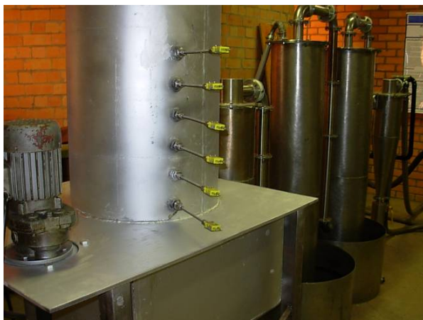
Figura 8. Sistema de medida de temperatura no reator de 300 mm.
