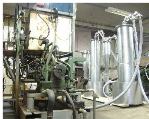
Figura 3. Linha de tratamento do gás de biomassa ao lado da bancada dinâmométrica de motores de combustão interna.
