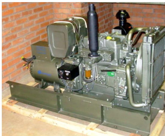
Figura 6. Grupo gerador diesel, 20 kVA, com motor diesel Yanmar BTM 33.
