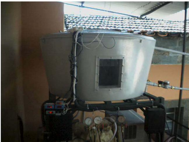
**Figura 2.** O reservatório de água quente e medidores de temperatura e pressão – Versão experimental e prática (excluindo visor)
