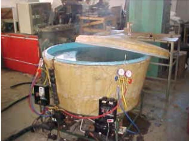
**Figura 1.** O reservatório de água quente e medidores de temperatura e pressão – versão experimental.
