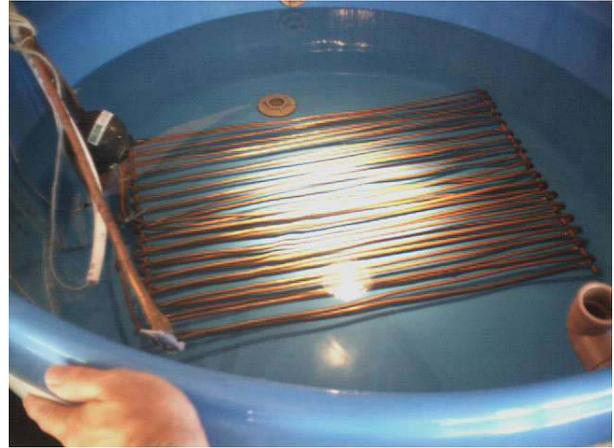
**Figura 3.** O condensador no interior do reservatório de água quente.
