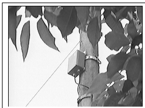
Figura 2- Unidade de sensoriamento e transmissão trifásica para instalação externa em poste
